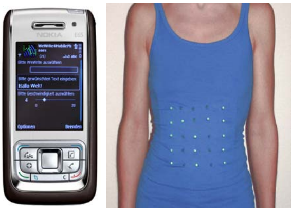
Abb. 8: WeWrite-Programm auf einem Mobiltelefon zur „On the Fly-Steuerung“ via Bluetooth (links) und Shirt (rechts), auf dem der Buchstaben „M“ aufleuchtet.
